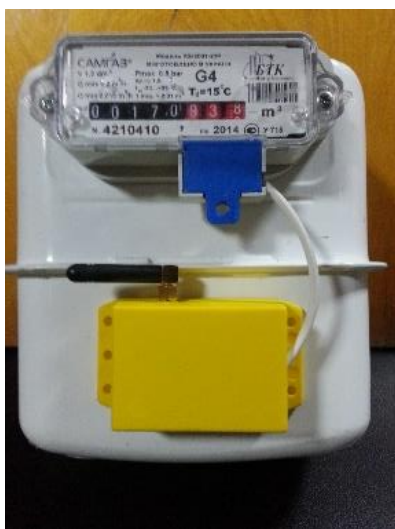
Фото 1. Пристрій дистанційної передачі даних до лічильника газу САМГАЗ
