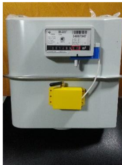
Фото 2. Пристрій дистанційної передачі даних до лічильника газу ELSTER
