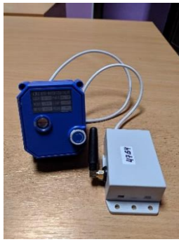
Рисунок 3. Зовнішній вигляд крана з клапаном і підключеним модулем БТМ-КВ МДУ дистанційного керування.
