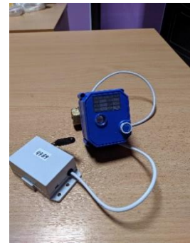
Рисунок 3. Зовнішній вигляд крана з клапаном і підключеним модулем БТМ-КВ МДУ дистанційного керування.
