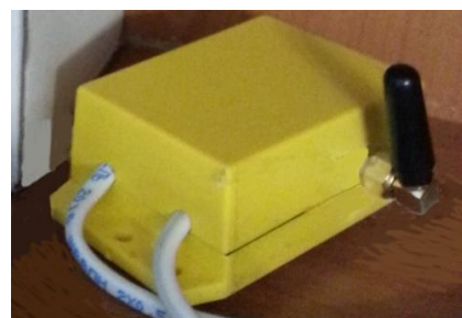
Рисунок 2. Зовнішній вигляд крана з клапаном і модуля БТМ-КВ МДУ дистанційного керування із входом для підключення датчика витоку води.
